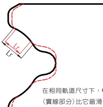
在相同軌道尺寸下，**cpc**滑軌（實線部分）比它廠滑軌（虛線部分）的鋼珠，有更大的軌道輪廓接觸面積。
